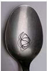
Büroklammer aus Nitinol verbogen, bei Raumtemperatur
