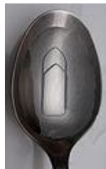
Büroklammer aus Nitinol erhitzt
